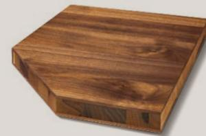
Die TEAM 7 3-Schicht-Technologie verbindet eine kompromisslose Ästhetik mit hervorragender Stabilität. Sie besteht aus drei Naturholzlagen, die kreuzweise aufeinander verleimt sind. Die Schichten sind jeweils um 90 Grad gedreht, was zu einer Absperrwirkung führt: Die einzelnen Schichten können nicht mehr ungehindert arbeiten. Dieser Effekt verleiht der TEAM 7 3-Schicht-Platte eine
