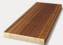
Die Tischlerplatte besteht aus nebeneinander liegenden, punktuell verleimten Leisten, die durch beidseitig quer aufgeleimte Furniere abgesperrt werden. Abschließend mit einem Edeldeckfurnier in Längsrichtung.
