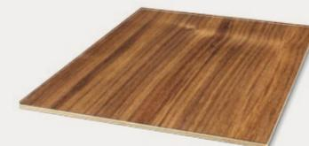
Die Furniersperrholzplatte besteht aus kreuzweise aufeinander geleimtem Schälffurnier mit abschließendem Edeldeckfurnier. Furniersperrholz besitzt daher eine hohe Festigkeit, Maßhaltigkeit und Formbeständigkeit.
